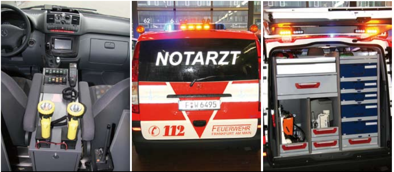
links: Blick auf die Mittelkonsole. Neben dem Funkhörer ist die Bedieneinheit für die Sondersignalanlage angeordnet. mitte: In der Kennsignaleinheit der Sondersignalanlage sind gelbe LED-Leuchten zur Heckabsicherung integriert. rechts: In die Heckklappe sind ebenfalls gelbe (und blaue) LED-Leuchten integriert, welche sich beim Öffnen der Heckklappe automatisch zuschalten.
