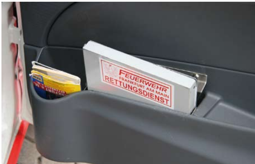
links: In der Beifahrertür wurde für die Schreibkladde mit den Notfallprotokollen eine spezielle Halterung eingebaut. rechts: Am Armaturenbrett befinden sich die Batteriekontrollanzeige und der Notstart-Taster.
