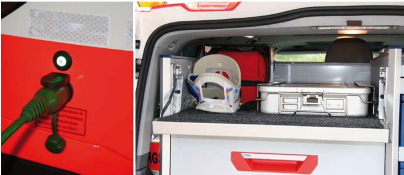
links: Auf beiden Fahrzeugseiten befindet sich eine Einspeisesteckdose mit einer grünen Kontroll-LED. rechts: Im Heck befindet sich links oben ein Fach mit einem chirurgischem Container, Verbrennungsset und Halsmanschette. Zur Vermeidung von Klappergeräuschen ist das Fach mit Filz ausgekleidet.
