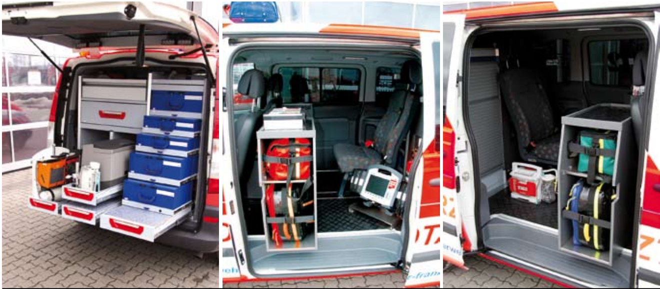
links: Blick auf den Heckauszug mitte: Fahrerseite des Innenraums. Auf dem Regal lagern drei Pakete Einmalhandschuhe. rechts: Der Innenraum der Beifahrerseite. Gut zu erkennen sind der Einzelsitz sowie der Schrank, in dem u. a. Persönliche Schutzausrüstung mitgeführt wird.
