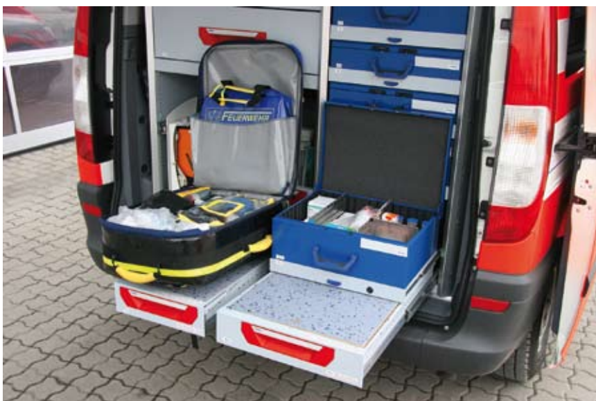
Die Sortimo-Koffer können auf dem Auszug ähnlich einer Schublade geöffnet werden.
